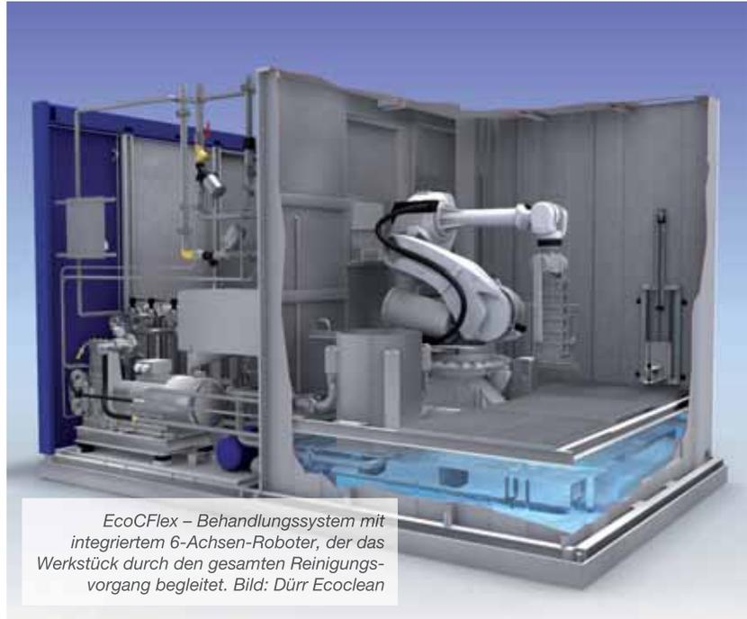
*EcoCFlex – Behandlungssystem mit integriertem 6-Achsen-Roboter, der das Werkstück durch den gesamten Reinigungsvorgang begleitet. Bild: Dürr Ecoclean*
