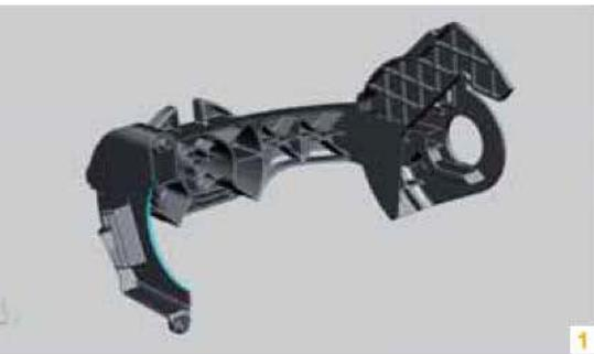
**1** Das Beispiel einer komplexen Geometrie mit 950 Merkmalen zeigt die Beschleunigung durch Synchronus-Technologie: Die Änderung am Durchmesser der kreisförmigen (türkisen) Oberfläche benötigt 1,5 Sekunden statt bisher 63.
