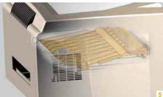
**5** Nachträgliche Änderungen erfordern schnelle, zuverlässige Bearbeitung. In diesem Beispiel kann die Versteifungsrippe der Papierzufuhr einfach gedreht werden, ohne die selbe Methode wie bei der Ersterstellung anzuwenden oder zu kennen.
