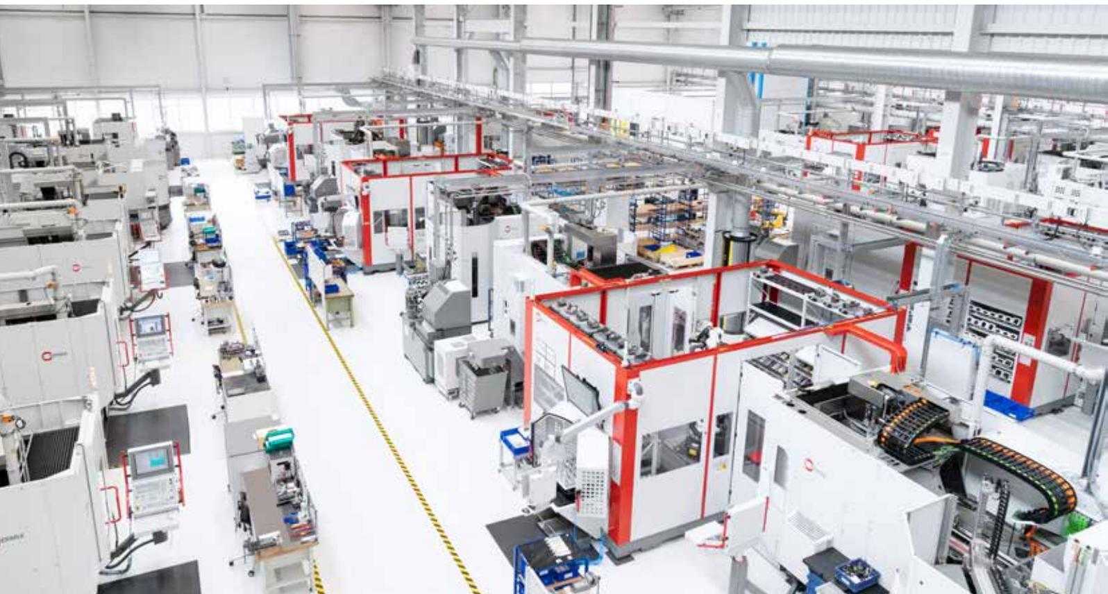
Bereits Prototypen und Kleinserien werden bei Stiwa vollständig über das 3D-CAM-Programmiersystem programmiert und seriennah gefertigt. Dank vereinheitlichter Spannmittel und Werkzeuge sind die Fertigungszentren in der Lage, selbsttätig zu rüsten.
