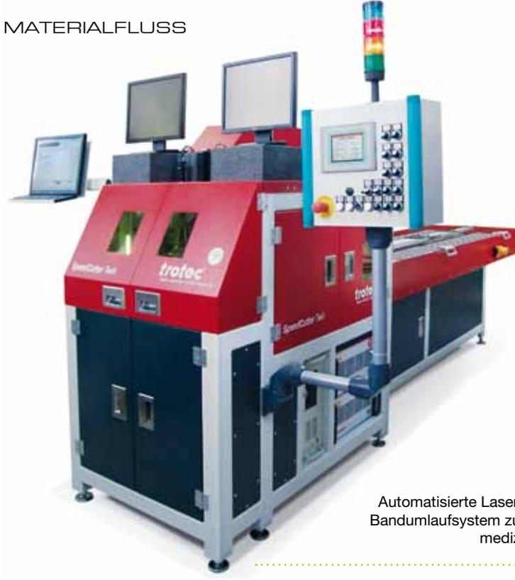
Automatisierte Laser-Markieranlage mit Bandumlauftsystem zur Beschriftung von medizinischem Besteck.
