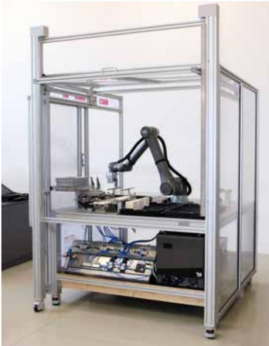
In einer Handlingsanlage legt der **integrierte Roboter innerhalb einer von TAT geschaffenen sicheren Einhausung** Keramikplatten in ein Spannsystem für den Zuschnitt ein und platziert dieses in der Schneidanlage.
