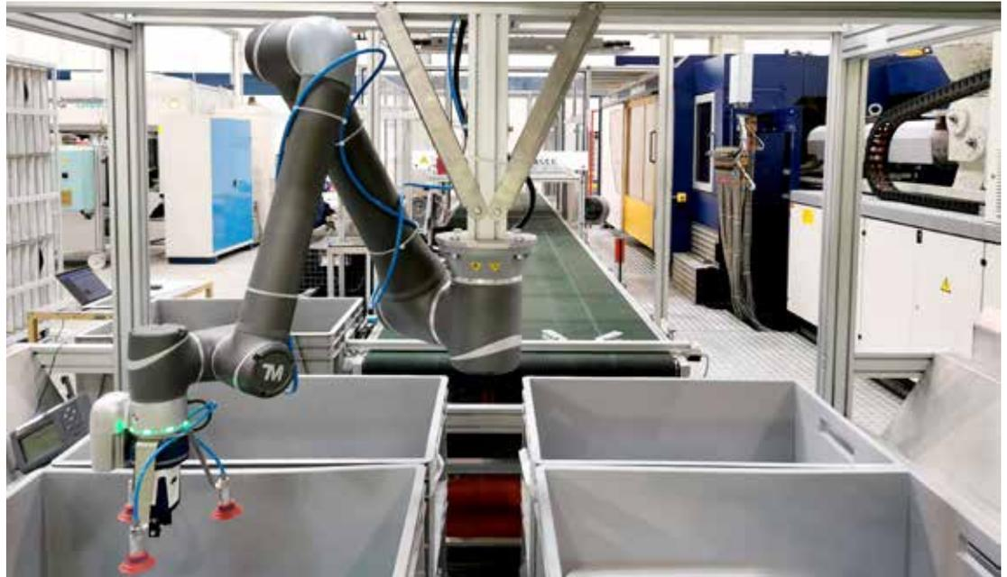
In Zusammenarbeit mit dem Joanneum Research schuf TAT eine kollaborative Lösung für das Einschichten von Kunststoffteilen in Kleinladungsträger und deren Palettierung. Ein um Vakuum-Funktionalitäten erweiterter Standard-Greifer ermöglicht die **Manipulation der Teile sowie der Fachböden und KLT ohne Greiferwechsel.**
