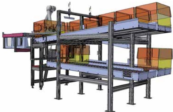
erfüllen sowohl die sicherheitstechnischen Vorschriften nach DIN EN ISO 10218-1 als auch die Anforderungen nach DIN ISO/TS 15066 für den kollaborierenden Betrieb. Das sorgt ebenso wie der eigensichere Aufbau der Förderbänder und -ketten aus dem TAT-Produktprogramm dafür, dass die Lösungen in vielen Fällen ohne eine sichere Einhausung und die damit einhergehenden Safety-Schaltungen auskommen.
