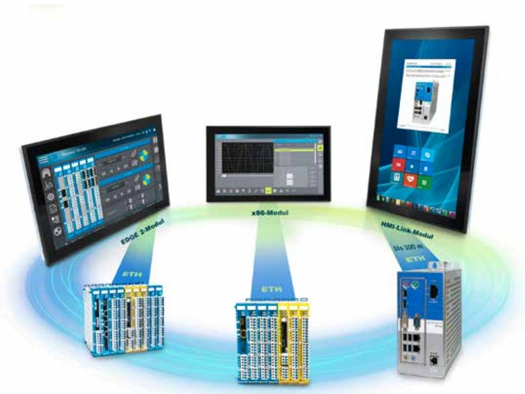
Die ETT-ModularWide-Panels sind als modularer Baukasten aus unterschiedlichen Anzeigeeinheiten und Interfacemodulen gestaltet, sodass sich Performance und Bildschirmgrößen beliebig kombinieren lassen.
