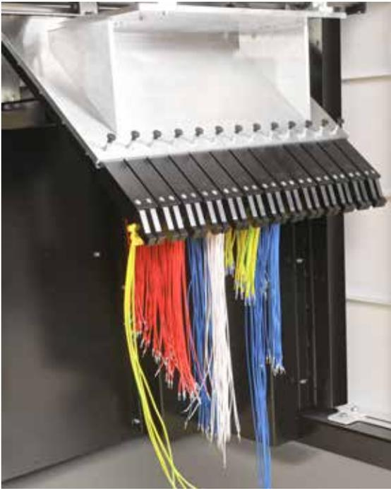
Für die Verlegung bereitgestellt werden die konfektionierten Drähte in der passenden Reihenfolge in einem **13-fachen Ablagesystem mit Schienenmagazinen, das bis zu 1.300 Drähte aufnehmen kann.**
