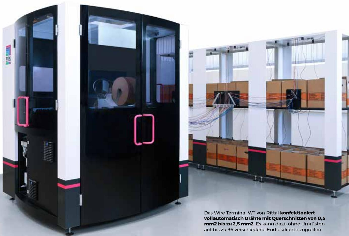
Das Wire Terminal WT von Rittal **konfektioniert vollautomatisch Drähte mit Querschnitten von 0,5 mm<sup>2</sup> bis zu 2,5 mm<sup>2</sup>**. Es kann dazu ohne Umrüsten auf bis zu 36 verschiedene Endlosdrähte zugreifen.
