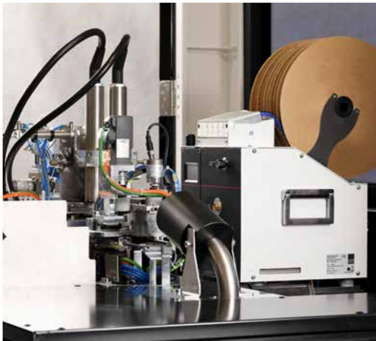
anschließende Aufcrimpen der Aderendhülsen. Dazu ist in der Standardversion ein Abisolier- und Crimpautomat RC-I vorgesehen. Dieser ermöglicht die Verarbeitung von fünf unterschiedlichen Leitungsquerschnitten von 0,5 mm<sup>2</sup> bis 2,5 mm<sup>2</sup>.
