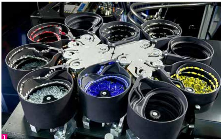
**1** Das Wire Terminal WT C verarbeitet kostengünstige lose Aderendhülsen aus fünf bzw. zehn Schwingfördertöpfen.
