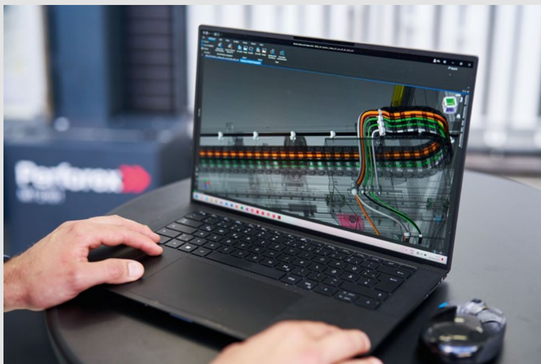
Eplan Cable proD ermöglicht die intuitive Erstellung des Digitalen Zwillings der Maschinenverkabelung. (Bild: Digital Fotogroup/ Michael Koch)
