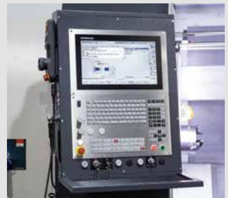
**Mit dem Programmgenerator smart.Turn** erzeugt die Heidenhain CNC Pilot 640 aus den Geometriedaten von Roh- und Fertigteil in wenigen Minuten automatisch das NC-Programm.
