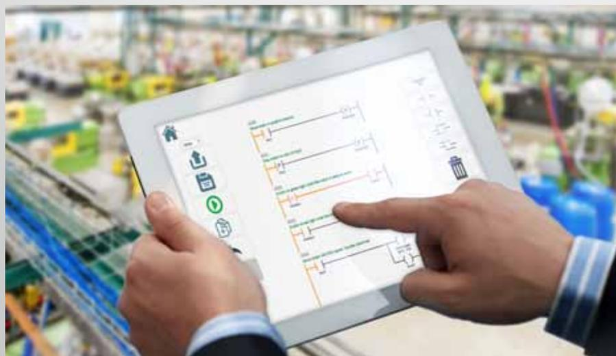
Mit der HTML5-Anwendung mapp CodeBox lassen sich Maschinenoptionen ohne Eingriff in das Hauptprogramm einfach mit Kontaktplan programmieren.
