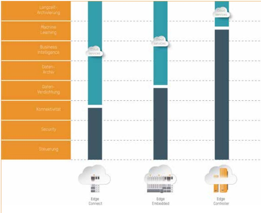
Mit Edge Connect, Edge Embedded und Edge Controller **bietet B&R drei Edge-Architekturen** als Lösung für unterschiedliche Anwendungsfälle an.
