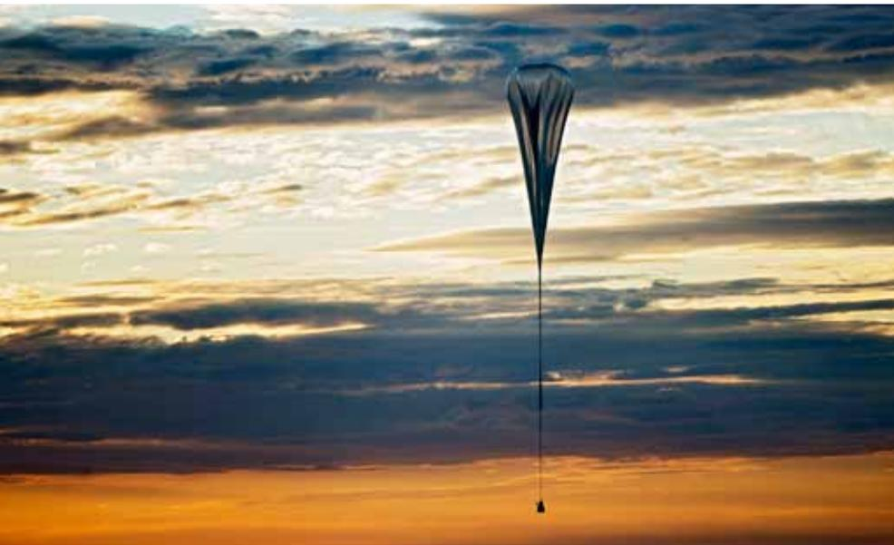
**oben** An einer Ballonhülle mit 10 µm Materialstärke hängend, erreichte die Kapsel den Ausstiegspunkt in knapp 40 Kilometern Höhe. (Foto: Red Bull)
