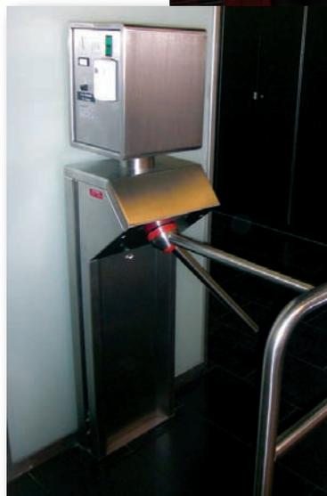
*Toiletten-Zugangslösung auf kleinstem Raum: Münzprüfer auf asymmetrischer Zweiarm-Drehsperre. Mit einer barrierefreien Offen-Stellung und in Kombination mit einer elektromagnetisch betätigten Falлтür ist diese fluchtwege- und Rollstuhltauglich.*
