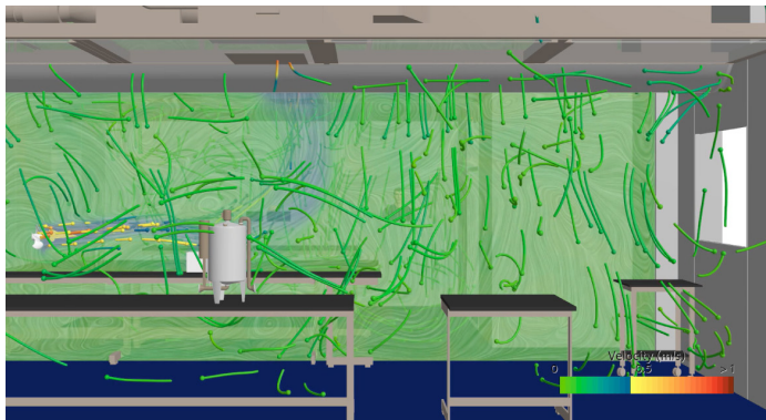
Abbildungen 3a und 3b: Die Simulationen lassen sich innerhalb weniger Stunden von Grund auf neu erstellen. Sie bieten leicht verständliche grafische Darstellungen von Partikelwolken oder Temperatur- und Druckverteilungen.
