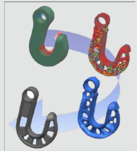
Ein Topologie-Optimierungsmodul schlägt nicht belastete Teile der Geometrie zum Weglassen vor. Zwischen der Ausgangsgeometrie links oben und dem vom Konstrukteur abschließend ausdetaillierten fertigen Teil liegt eine erhebliche Materialeinsparung.
