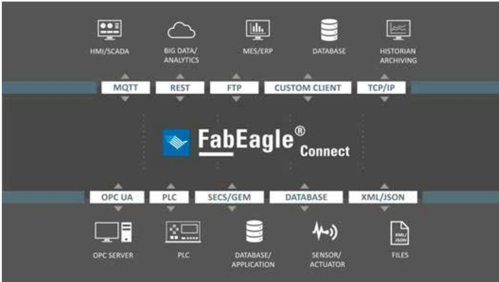
**FabEagleConnect für die Schnittstellenintegration fasst alle gängigen Protokolle zusammen** und hilft Anlagenherstellern und -betreibern so, die mangelnde Einheitlichkeit in der industriellen Datenkommunikation zu überwinden und die Abhängigkeit von den Herstellern der einzelnen Anlagenteile zu verringern.
