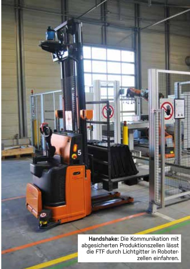
**Handshake:** Die Kommunikation mit abgesicherten Produktionszellen lässt die FTF durch Lichtgitter in Roboterzellen einfahren.
