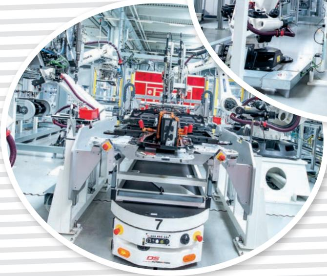
Die Batteriemontage mittels Fahrerlosem Transportsystem lässt sich nahtlos in den Produktionsprozess und die Intralogistik integrieren.
