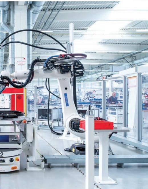
Die Batteriemontage erfolgt mit hohem Automatisierungsgrad in 10 bis 12 Stationen, von denen viele als geschlossene Roboterzellen ausgebildet sind. Fahrerlose Transportsysteme ermöglichen hohe Flexibilität und lassen sich nahtlos in Produktionsprozesse und Intralogistik integrieren.
