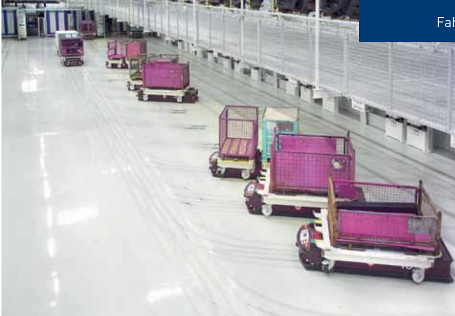
DS Automation bietet für die Intralogistik auch Serienprodukte wie diese Unterfahr-Fahrzeuge, die in einem BMW-Werk die Teileversorgung JIT/JIS sicherstellen.
