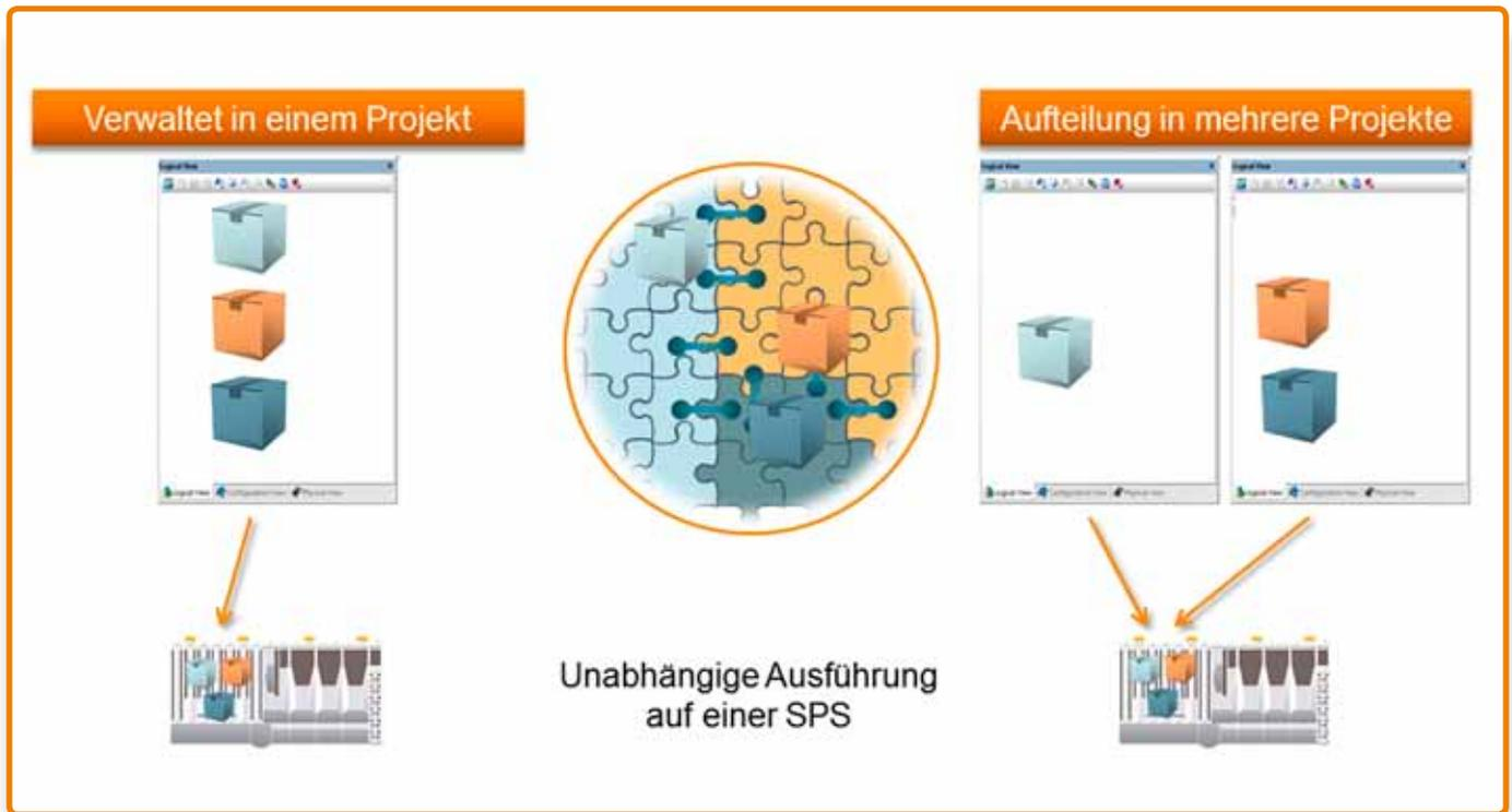
Die modulare Entwicklung der Maschinensoftware kann wahlweise in einem großen Projekt oder aufgeteilt auf mehrere kleinere Projekte erfolgen. Die autark lauffähigen Applikationsmodule können parallel auf einer Steuerung getestet, diagnostiziert und bearbeitet werden – dies spart wertvolle Inbetriebnahmezeit.
