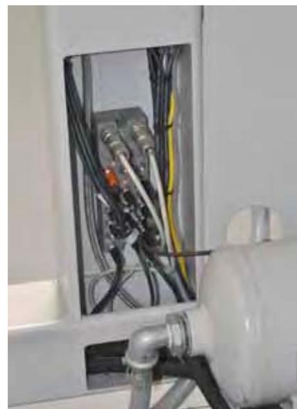
Auch Ein- und Ausgangsmodule in IP67 können direkt in die Mechanik integriert werden und tragen so wesentlich zur Modularisierung bei. Als X67 SafeIO sind sie auch in sicherer Ausführung erhältlich.
