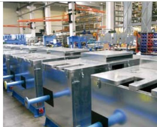
**Der servoelektrische Pumpenantrieb senkt die Geräuschemissionen um 15 dB und macht umfangreiche und teure Lärmschutzmaßnahmen wie bei diesen klassischen Verstellpumpenantrieben überflüssig.**
