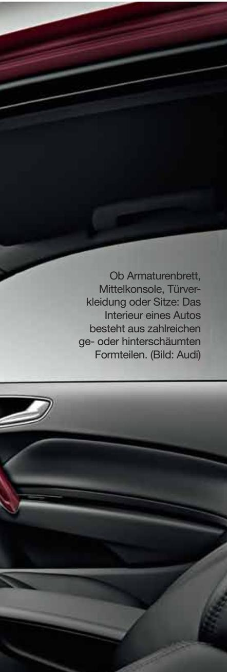
Ob Armaturenbrett, Mittelkonsole, Türverkleidung oder Sitze: Das Interieur eines Autos besteht aus zahlreichen ge- oder hinterschäumten Formteilen. (Bild: Audi)
