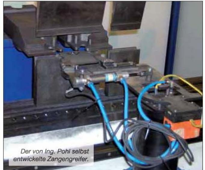
Der von Ing. Pohl selbst entwickelte Zangengreifer.
