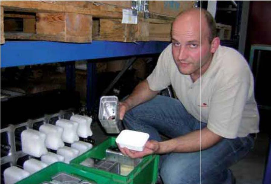
Unterschiedlich tiefe Becher mit einheitlicher Grundfläche werden mittels verschiedener Einsätze aus einem einzigen Werkzeug hergestellt. Oft werden diese Jahre später als das Urwerkzeug bestellt.
