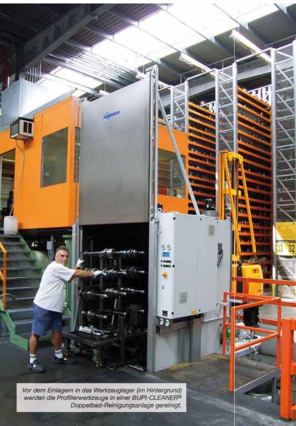
Vor dem Einlagern in das Werkzeuglager (im Hintergrund) werden die Profilierwerkzeuge in einer BUPI-CLEANER® Doppelbad-Reinigungsanlage gereinigt.
