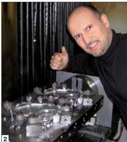
**2** Günther Forsthuber, Geschäftsführer und technischer Leiter von KFG, erläutert eine Aufspannvorrichtung für die Bearbeitung von Dichtflanschen in einer Doppelspindelmaschine. Die einzelnen Spannelemente sind frei justierbar, um Positionsabweichungen zwischen verschiedenen Maschinen des selben Typs auszugleichen.
