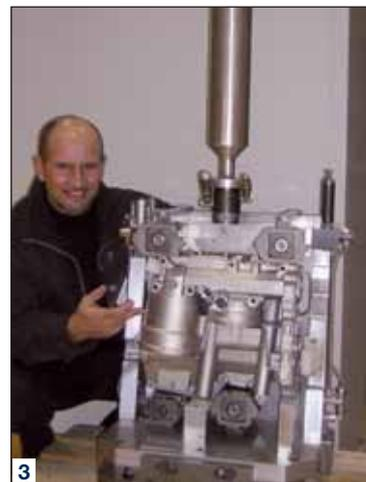
**3** Der hier eingespannte Kraftstoff-Filter für LKW ist mit neun Kilogramm nicht nur der größte Teil, der hier bearbeitet wird. Er wird mit nur zwei Spannvorgängen in dieser beeindruckenden Vorrichtung auf allen Seiten bearbeitet und mit Einpressteilen bestückt.
