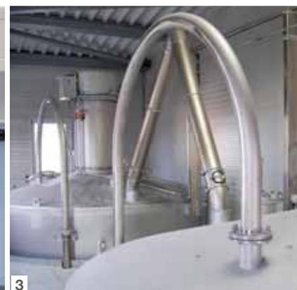
Mit dem patentierten Geroldinger-Oszillomat wird das Ausgangsmaterial in einem gemeinsamen Vorgang aus den Silos ausgetragen und dosiert.
