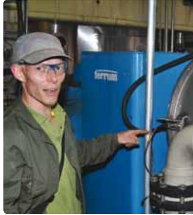
**links** Schwankungen der Zusammensetzung des Salzbreis im dreistufigen Produktionsprozess für das Glaubersalz können zur Überlastung der Schub-zentrifugen führen ...
