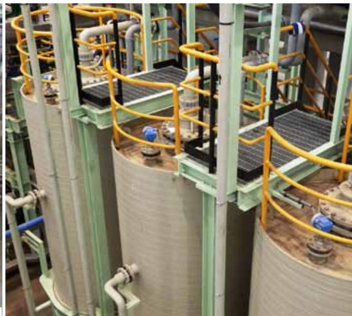
ze die Mischsäure-Beizsektion mit einem Gemisch aus Flußsäure und Salpetersäure, die dem Material seine chemische Reinheit sichert. Dabei wird die Mischsäure mit Metall versetzt und verliert ihre Wirksamkeit.
