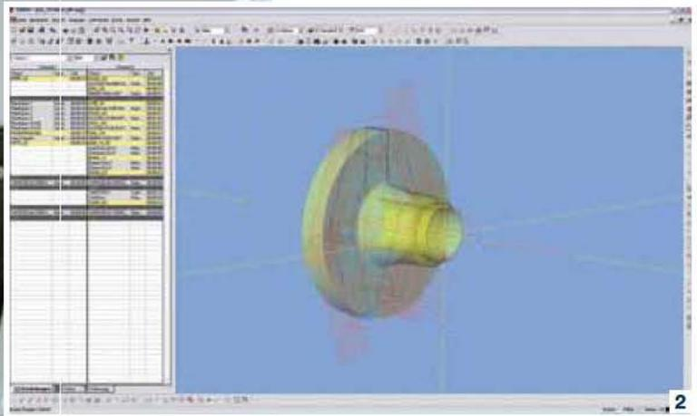
**1, 2** Die bisher übliche Programmierung direkt an der Maschine wich der komfortablen Offline-Programmierung am Laptop mittels ESPRIT von direkt importierten 3D-Konstruktionsdaten.
