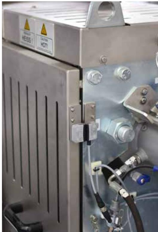
**Zur Überwachung der Hydraulik-kolbenschutztür** am Schmelzefilter kommt ein magnetisch codierter Sicherheits-sensor eloProtect M 153MSK zum Einsatz.
