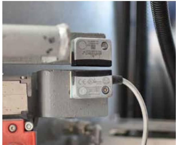
**links** Gegenüber RFID-Sensoren punktet der eloProtect M 153MSK mit einem **erweiterten Temperaturbereich**. Die in Erema-Maschinen eingesetzte Konfiguration ist von -25 bis +80 °C getestet.
