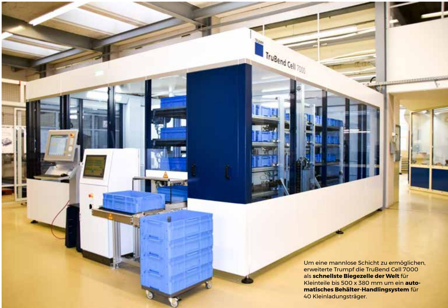
Um eine mannlose Schicht zu ermöglichen, erweiterte Trumpf die TruBend Cell 7000 als **schnellste Biegezone der Welt** für Kleinteile bis 500 x 380 mm um ein **automatisches Behälter-Handlingsystem** für 40 Kleinladungsträger.
