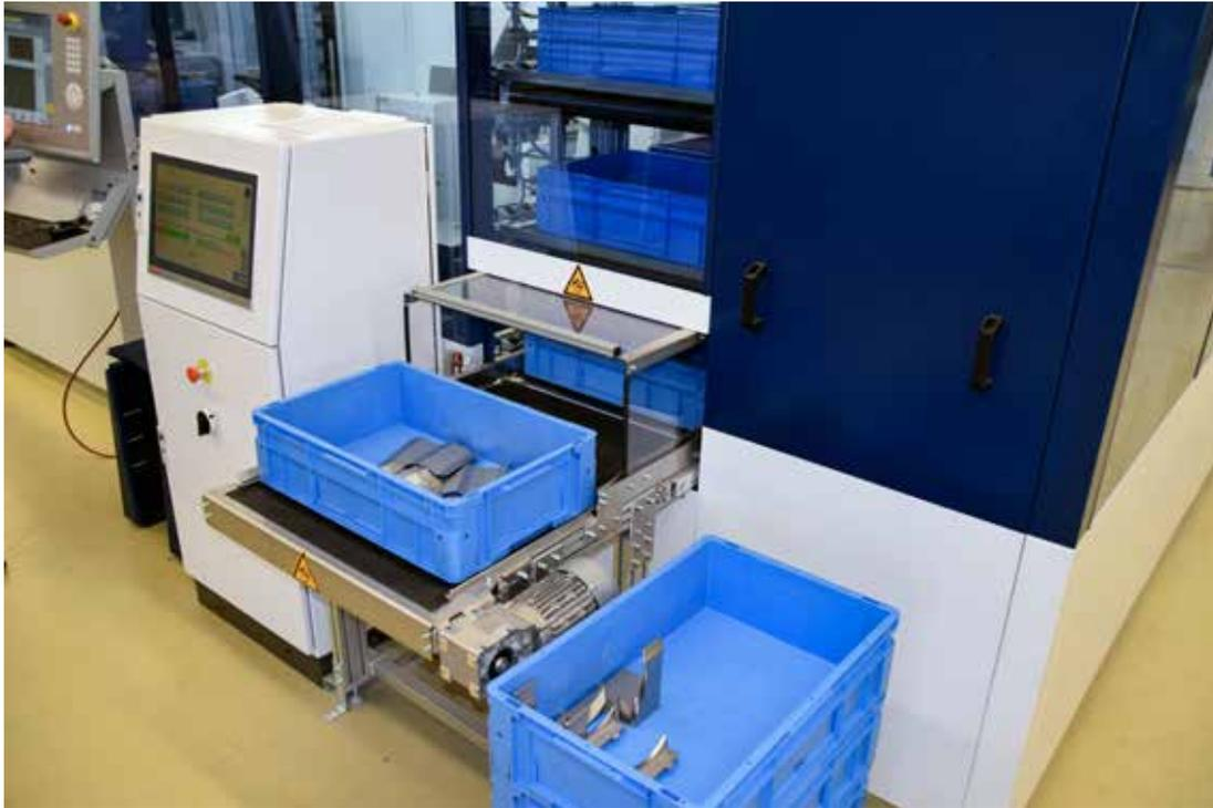
Um dem begrenzten Platzangebot Rechnung zu tragen und die funktionale Sicherheit zu gewährleisten, befindet sich das **automatische Regalsystem im Inneren der nur leicht vergrößerten Zelle.**
