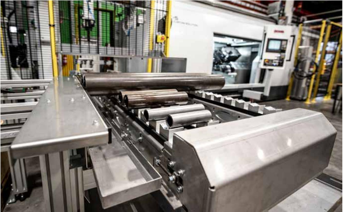
von einem Zuführband angeliefert. Von dort bringt ein Portallader die Rohlinge zur Ladeluke und in die Maschine zur Einspannung. Die fertig bearbeiteten Werkstücke gelangen per Portallader zu einem Abfuhrband am anderen Ende der Anlage, das sie aus der Maschine
