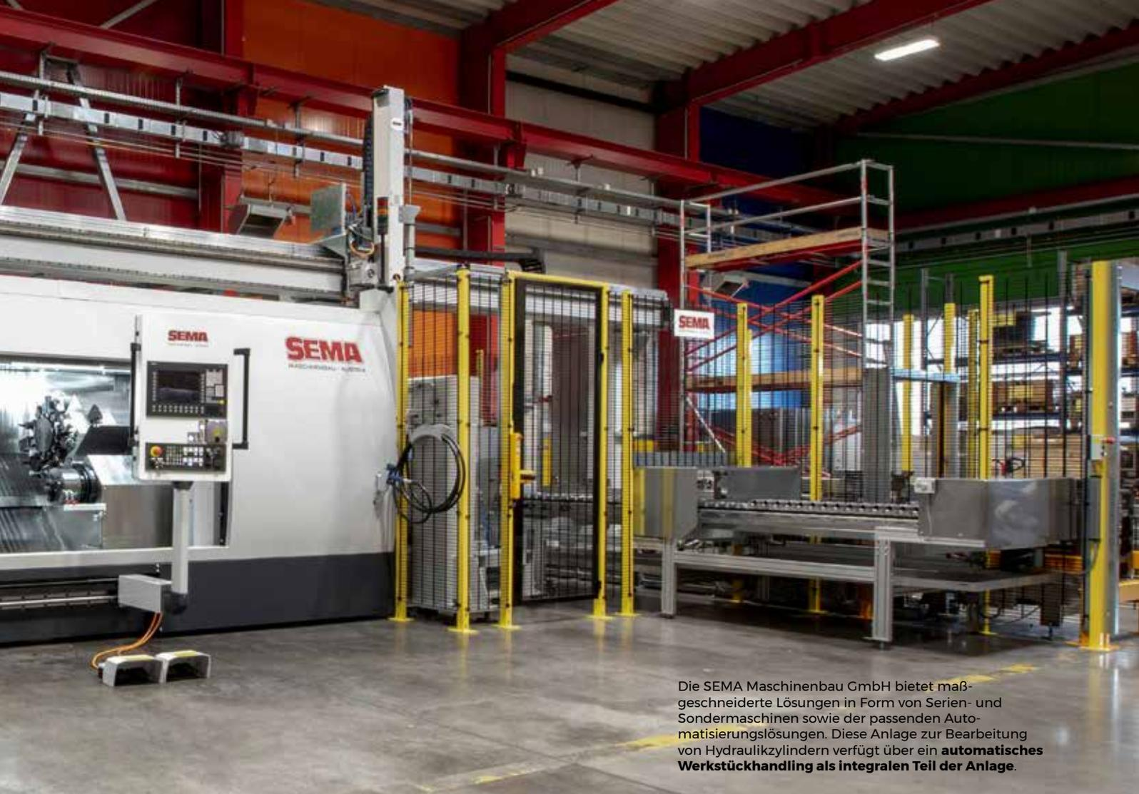
Die SEMA Maschinenbau GmbH bietet maßgeschneiderte Lösungen in Form von Serien- und Sondermaschinen sowie der passenden Automatisierungslösungen. Diese Anlage zur Bearbeitung von Hydraulikzylindern verfügt über ein **automatisches Werkstückhandling als integralen Teil der Anlage.**
