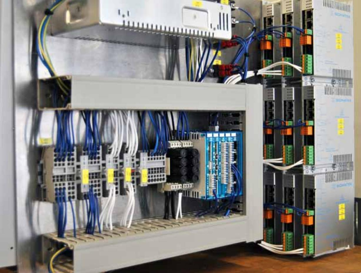
Beim kleineren Modell Hage3D 72L ist das gesamte Automatisierungssystem in einem einzigen Schaltkasten untergebracht. Die begonnene Entwicklung von Schrittmotor-Endstufen im S-DIAS Formfaktor wird einen weiteren Miniaturisierungsschritt ermöglichen.
