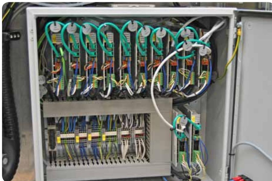
Beim größeren Modell Hage3D 140L ist die Automatisierungstechnik auf zwei Schaltkästen aufgeteilt. Der Leistungsteil nutzt zur Ansteuerung der Schrittmotoren die Schrittmotor-Endstufen VST 011 von Sigmatek.
