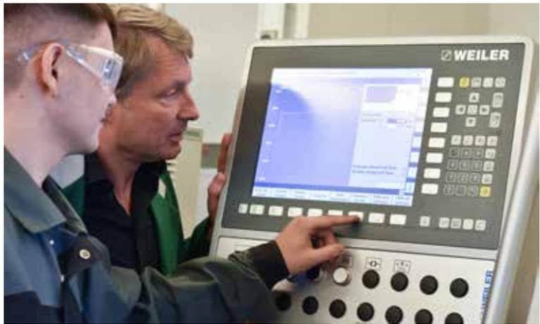
Die SL2-Steuerung von Weiler erlaubt das **Abrufen vorgefertigter Bearbeitungszyklen** und verleiht der Maschine Flexibilität bei geringstem Programmieraufwand. Ihr 15“-Monitor erleichtert den Lehrbetrieb.
