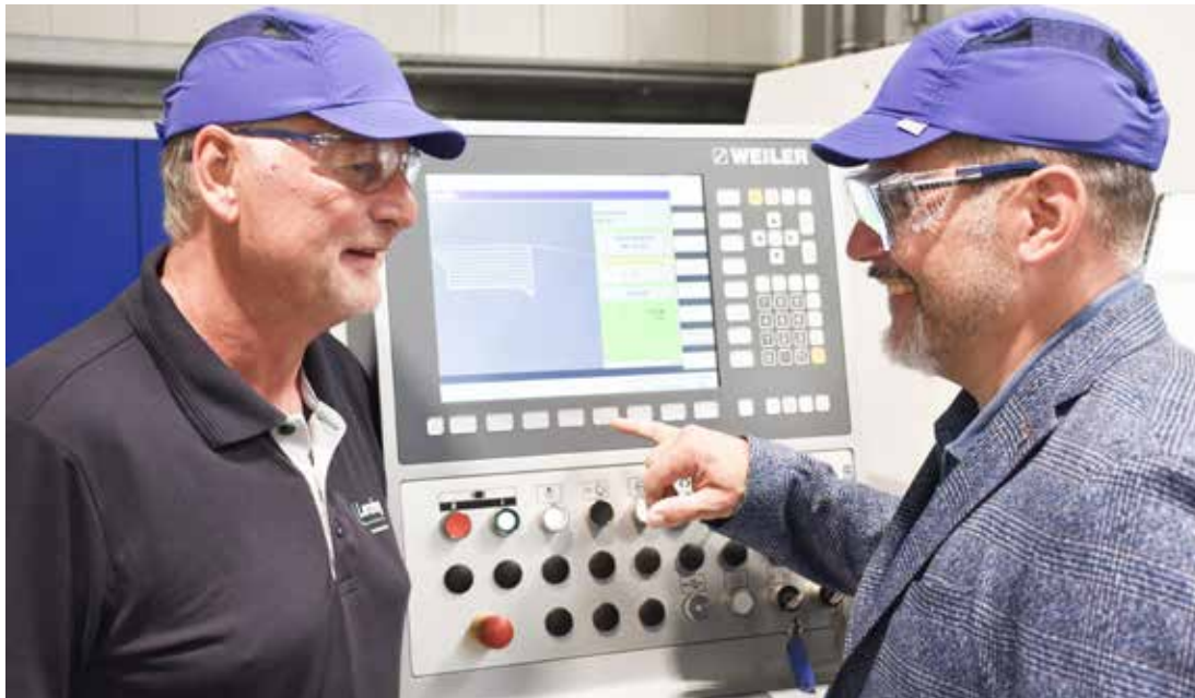
Die SL2-Steuerung von Weiler mit 15"-Monitor erlaubt das Abrufen vorgefertigter Bearbeitungszyklen und verleiht der Maschine Flexibilität bei geringstem Programmieraufwand.
