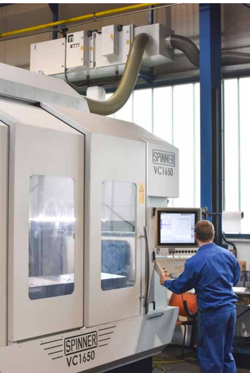
Jüngster Zugang im Maschinenpark von Roither Maschinenbau ist ein 5-Achs-Bearbeitungszentrum VC1650-5A von Spinner.
