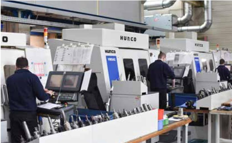
Bei einigen Maschinen kam es immer wieder zu einer starken Geruchsbildung. Zusätzlich bildeten sich **zementartige Ablagerungen, die zu Schäden bis hin zum Spindelbruch führten.** Das nötigte zum häufigen Austausch der Emulsion und führte zu ungeplanten Maschinenstillständen.
