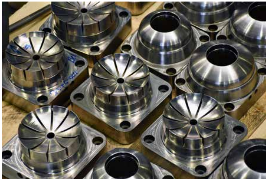
Die Teile für die Spritzgießformen fertigt Mangel überwiegend mittels Senkerodieren.
