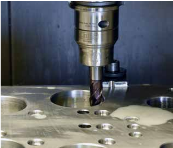
Für die Hartbearbeitung pulvermetallurgischer Stähle verwendet Mangel Fräser der Serie HPC von Meusburger und führt aktuell Tests mit den Fräsern der Serie WZF für gehärtete Stähle bis 67 HRC durch.
