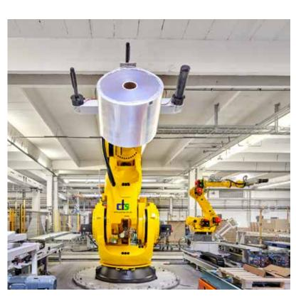
Die Endverpackung der aufgerollten Folien in insgesamt 1.500 möglichen Packbildern erfordert eine enorme Flexibilität. Wegen der hohen Stückgewichte bis 1,5 Tonnen kommt – erstmals in Europa – ein **Schwerlastroboter M-2000iA/2300 von Fanuc mit 2,3 Tonnen Tragfähigkeit** zum Einsatz.
