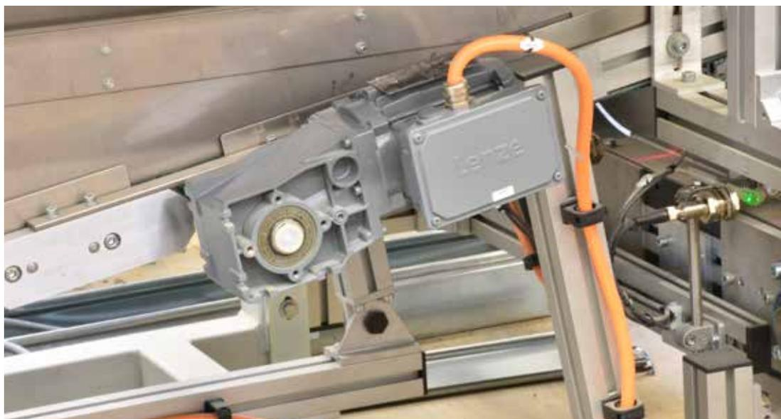
Für die unterschiedlichen Anwendungen sind in der Muffenaufweitungsanlage in Summe **zwölf Motoren und Aktuatoren unterschiedlicher Größen und Bauarten** verbaut. Im Bild ein Getriebemotor der Reihe g500 als Förderbandantrieb. (Bild: x-technik)
