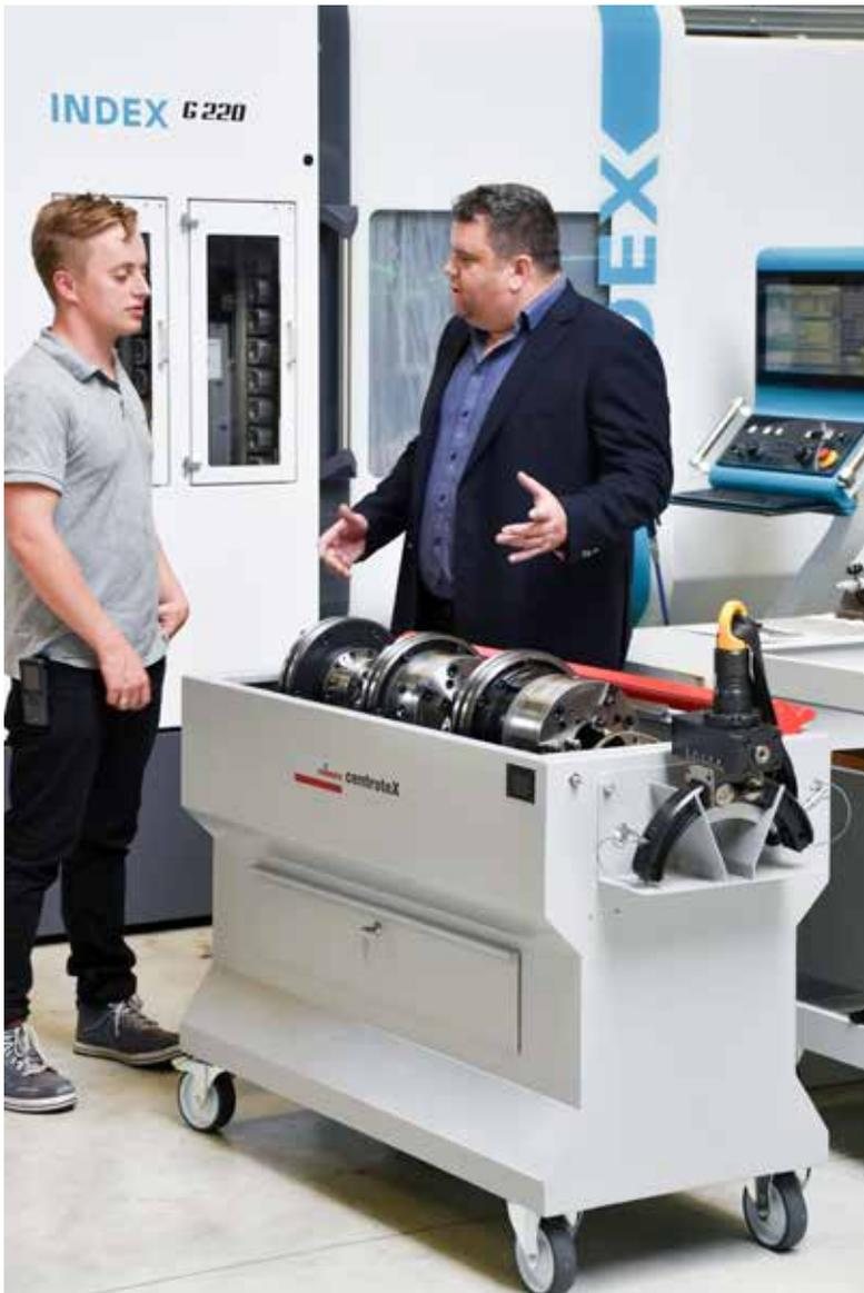
Für die saubere, geordnete und mobile Aufbewahrung der Spannmittel des **Schnellwechsel-Systems centroteX von Hainbuch** sorgt ein Spannmittel-Rollcontainer. An dessen Stirnseite sichtbar ist die Montagehilfe Monteq für die gefederte Aufnahme der Spannmittel durch den Lastkran.
