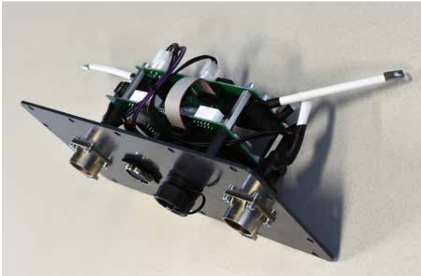
Den Geräten der Pro-Serie verleiht das im Haus entwickelte Power Safety Board Hot-Plug-Fähigkeit.
