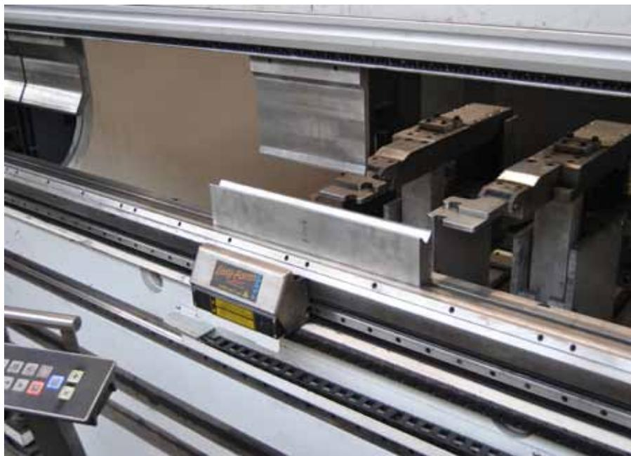
Mithilfe des im integrierten Messsystem vorhandenen Lasers zeigt die Steuerung dem Maschinenführer direkt an der Maschine die Positionen der Abkantwerkzeuge und beschleunigt so den Rüstvorgang für jeden neuen Teil.
