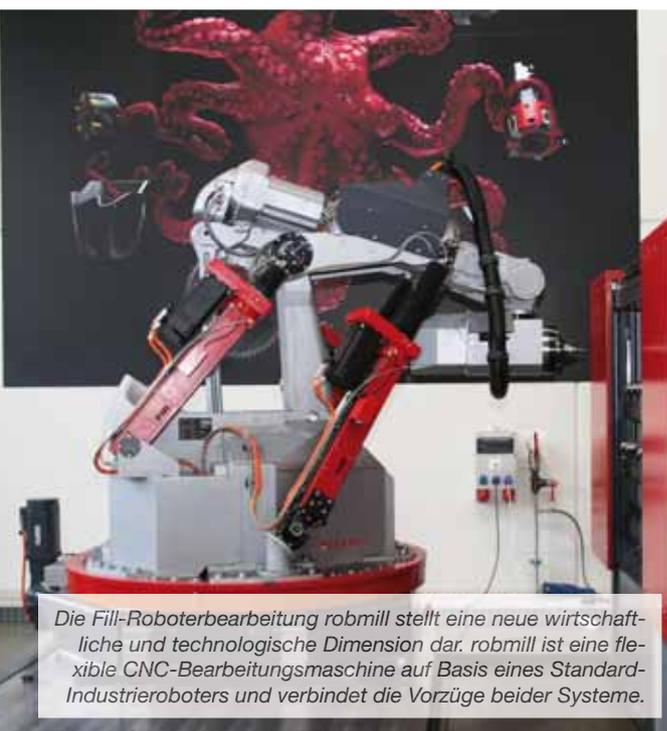
Die Fill-Roboterbearbeitung robmill stellt eine neue wirtschaftliche und technologische Dimension dar. robmill ist eine flexible CNC-Bearbeitungsmaschine auf Basis eines Standard-Industrieroboters und verbindet die Vorzüge beider Systeme.
