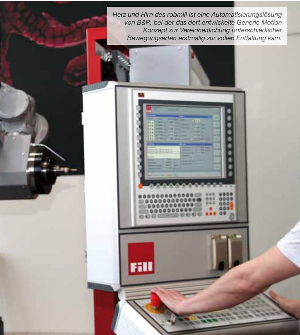
Herz und Hirn des robmill ist eine Automatisierungslösung von B&R, bei der das dort entwickelte Generic Motion Konzept zur Vereinheitlichung unterschiedlicher Bewegungsarten erstmalig zur vollen Entfaltung kam.
