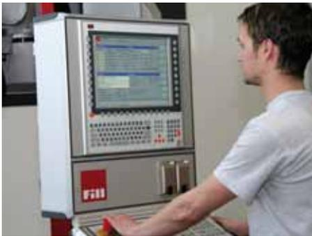
Die originale Robotersteuerung des robmill wurde mit Hilfe des Automatisierungsspezialisten Bernecker + Rainer durch eine von Fill weiterentwickelte CNC-Steuerung ersetzt.
