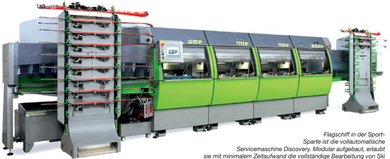
*Flagschiff in der Sport-Spartenmaschinentheorie ist die vollautomatische Servicemaschine Discovery. Modular aufgebaut, erlaubt sie mit minimalem Zeitaufwand die vollständige Bearbeitung von Ski und Snowboards vor jedem neuen Verleihvorgang.*
