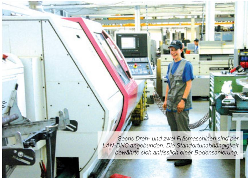
Sechs Dreh- und zwei Fräsmaschinen sind per LAN-DNC angebunden. Die Standortunabhängigkeit bewährte sich anlässlich einer Bodensanierung.
