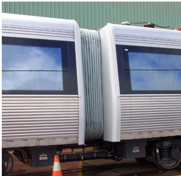
Bild 1: Ein typischer Wagenübergang an einem Triebwagenzug aus kurzgekuppelten Einzelfahrzeugen
